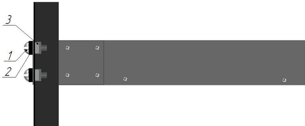
1-винт, 2-шайба, 3-закладная квадратная гайка
