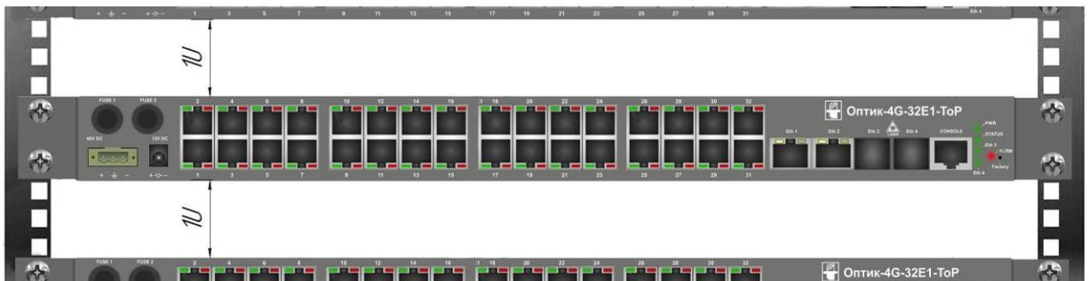
Рис. 2.3 - Установка в стойку
