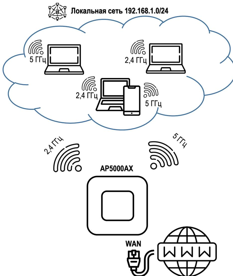
Рисунок 32 – Схема подключения «Точка доступа»
