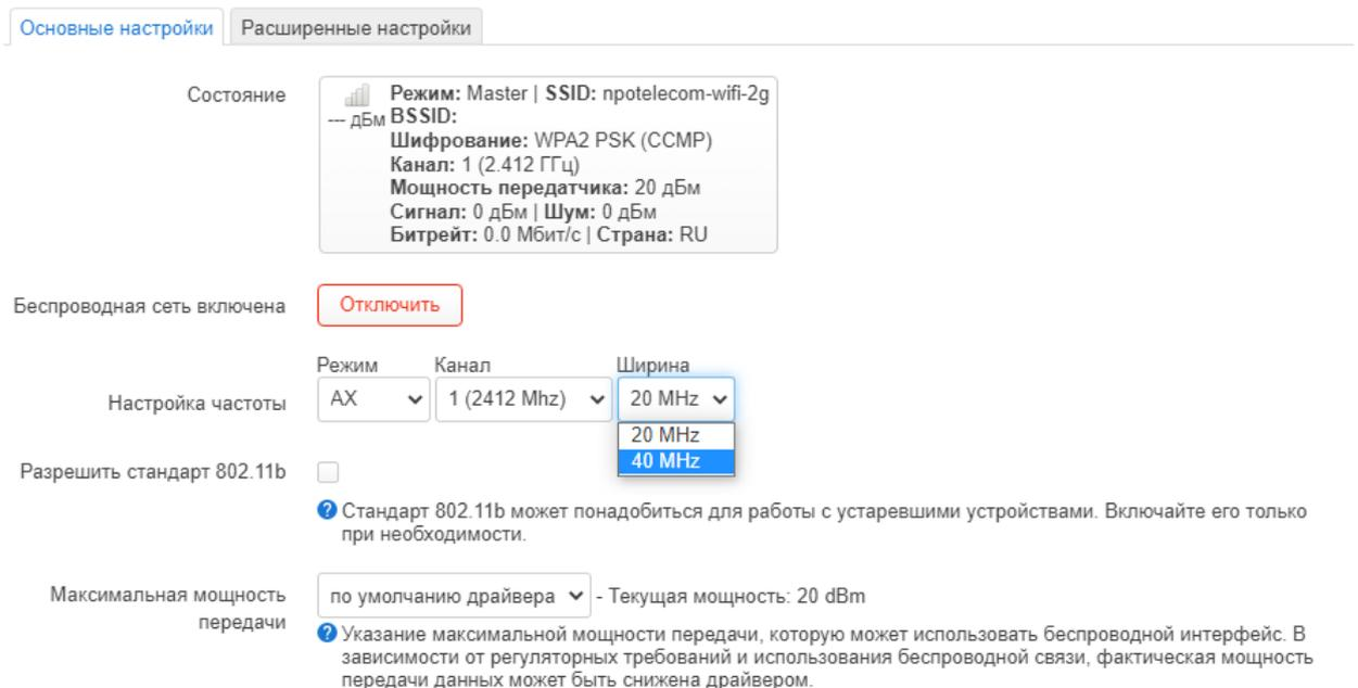
Рисунок 36 – Выбор ширины канала для частоты 2,4 ГГц
