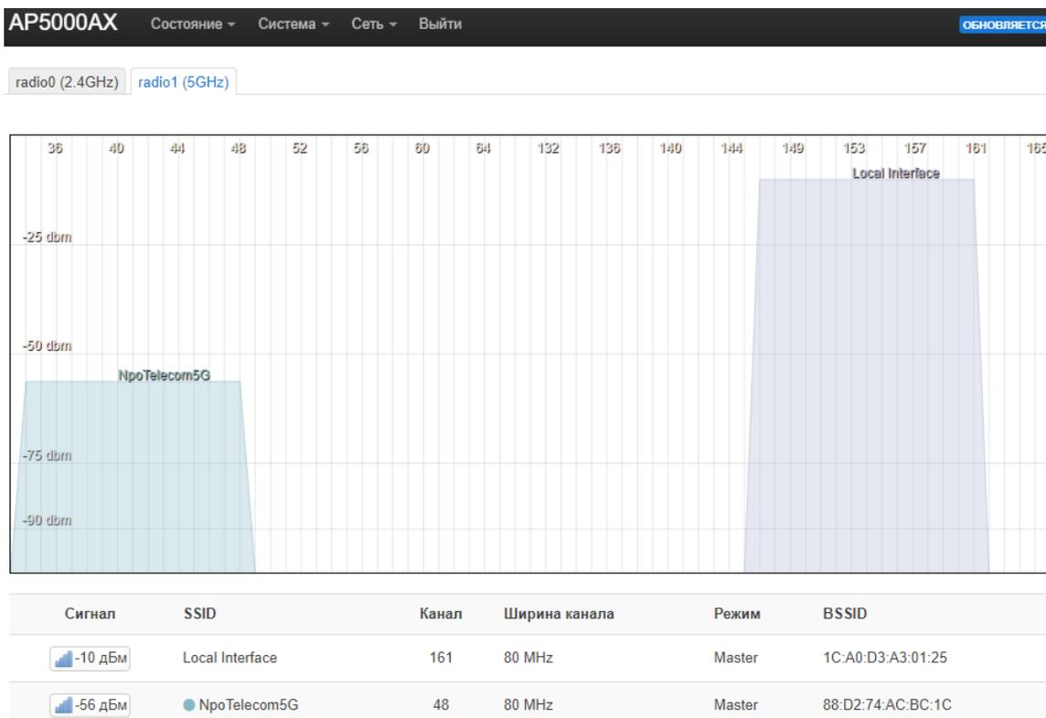
Рисунок 6 – Анализ радиоэфира в диапазоне частот 5 ГГц
