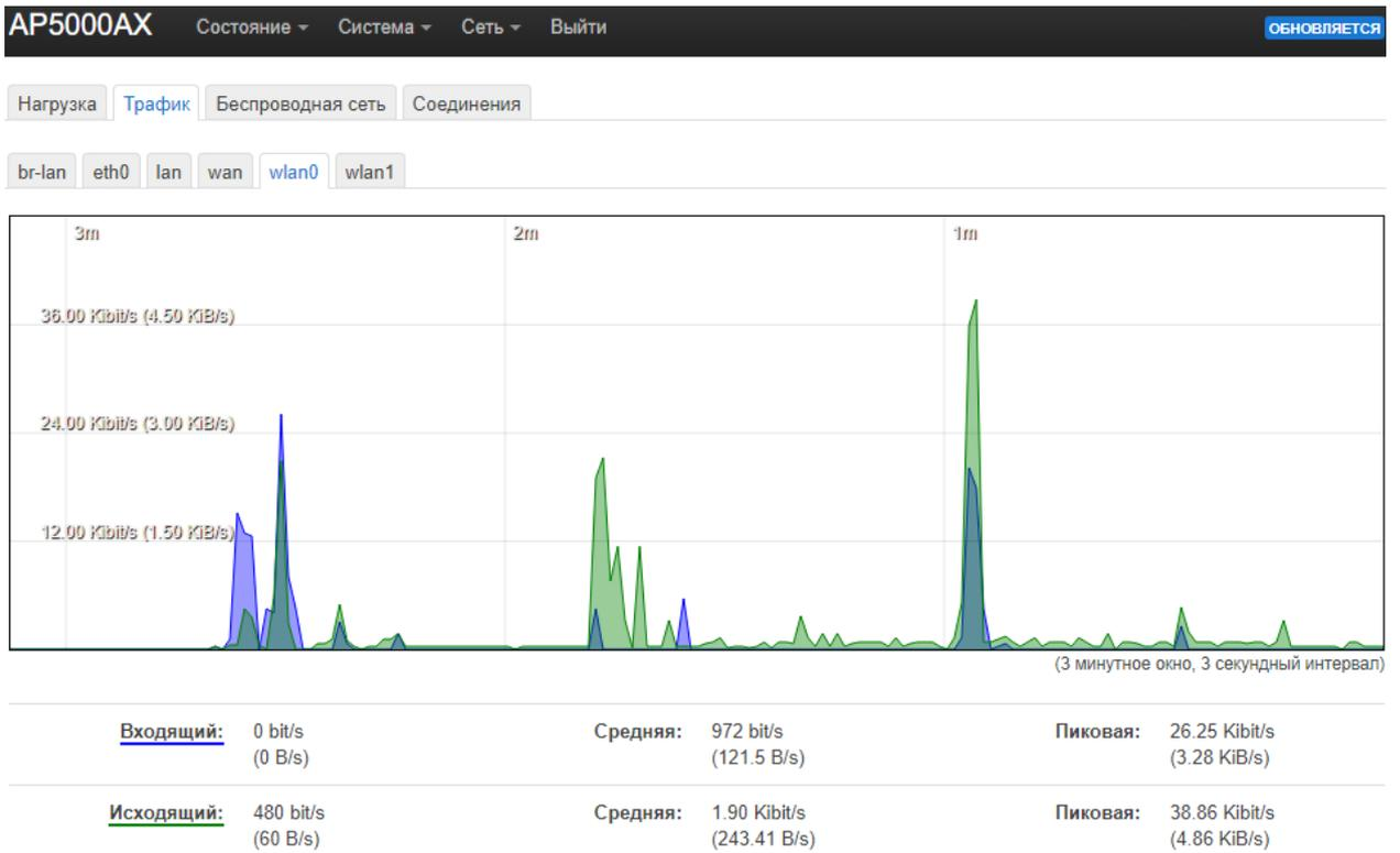
Рисунок 9 – Трафик через Wi-Fi 2,4 ГГц
