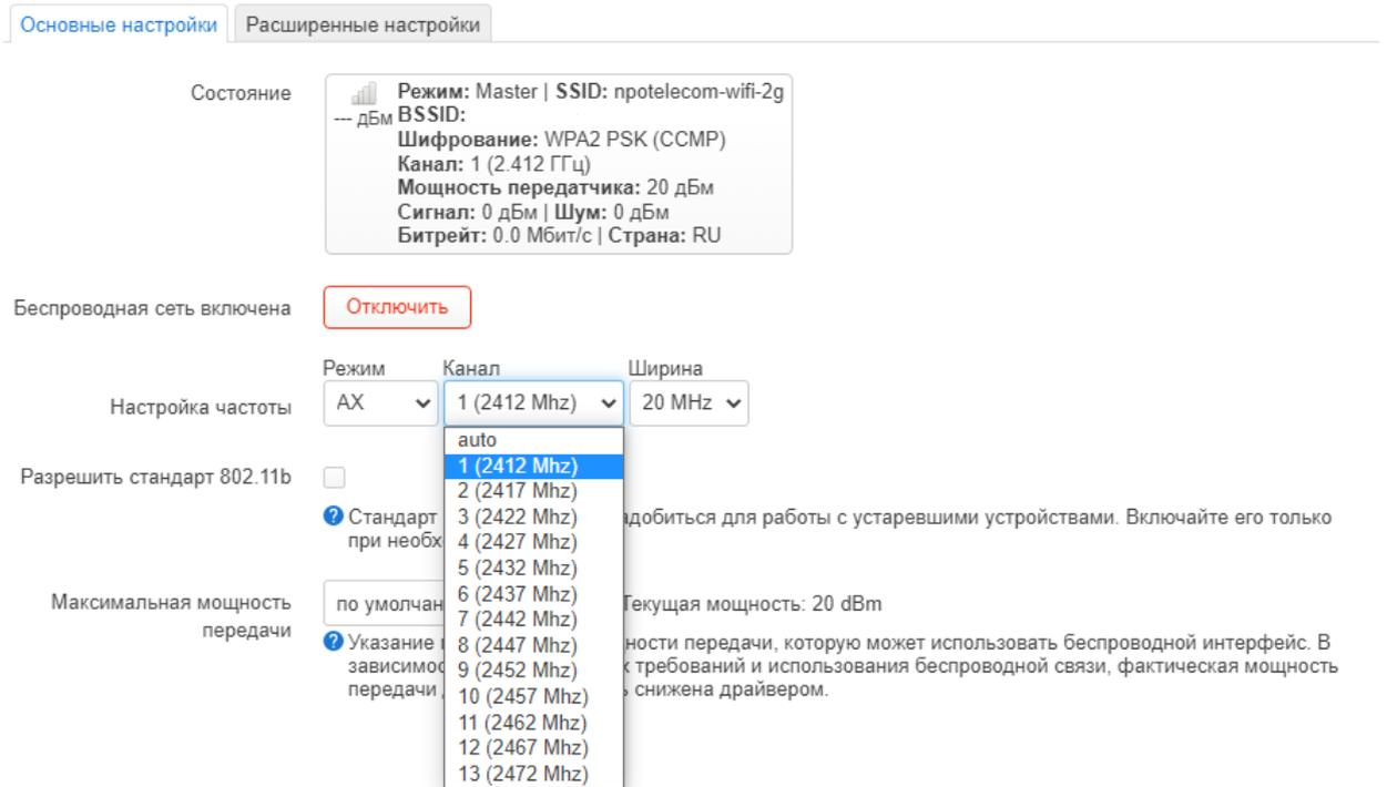
Рисунок 35 – Выбор канала для частоты 2,4 ГГц
