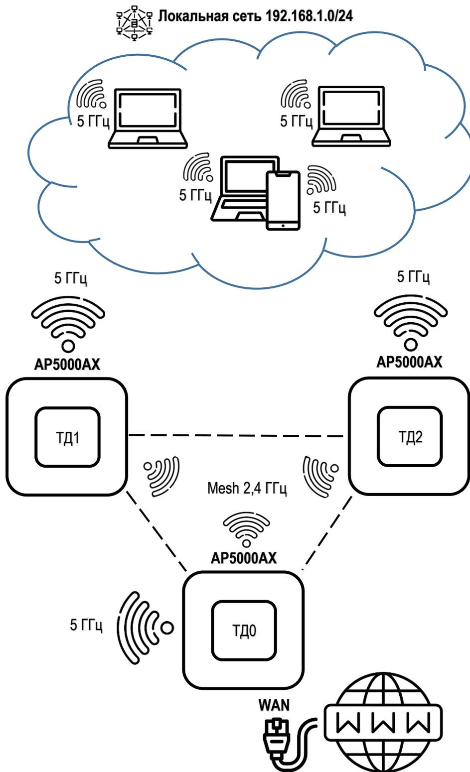
Рисунок 65 – Схема Mesh-сети
