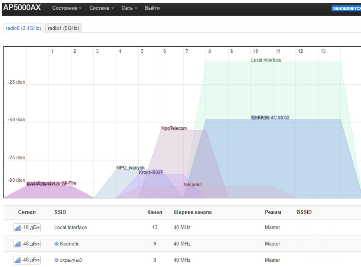
Рисунок 5 – Анализ радиоэфира в диапазоне частот 2,4 ГГц
