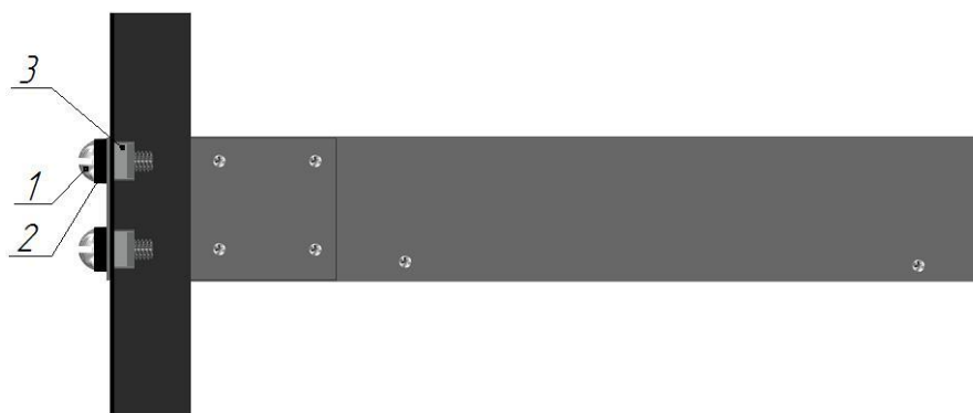
1 – гайка скоба, 2 – шайба, 3 – винт.
