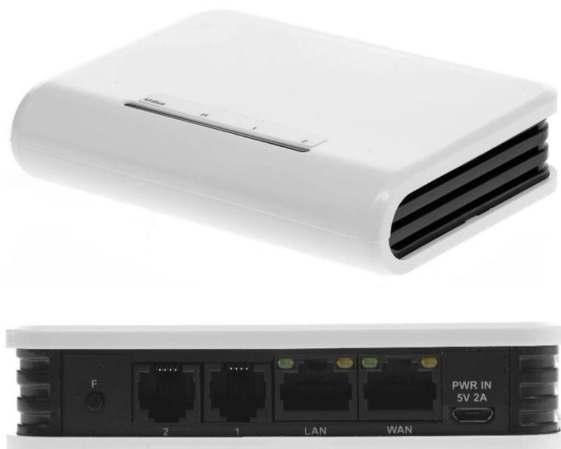
Рисунок 1.2 – Внешний вид VoIP шлюз Телеком-MG-2-FXS-R
