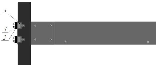
1 – гайка скоба, 2 – шайба, 3 – винт.
