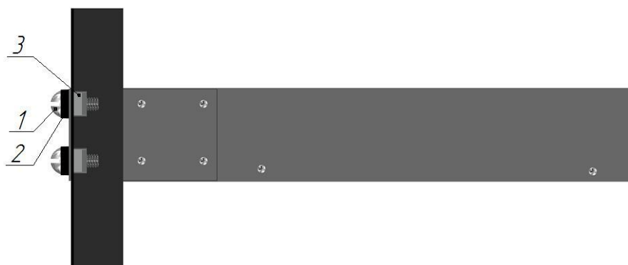
1 – гайка скоба, 2 – шайба, 3 – винт.
