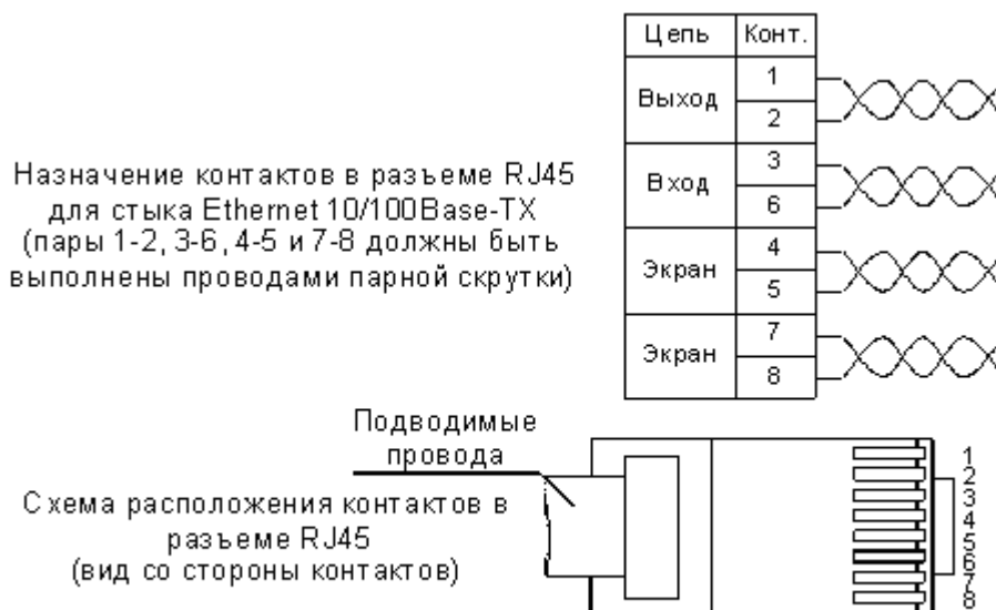
Рис. 2.2 - Назначение контактов в разъеме RJ45
