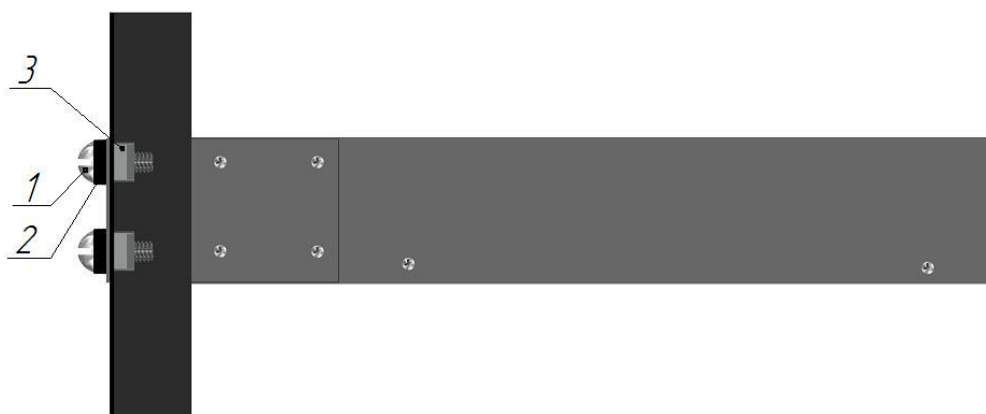
1-винт, 2-шайба, 3-закладная квадратная гайка
